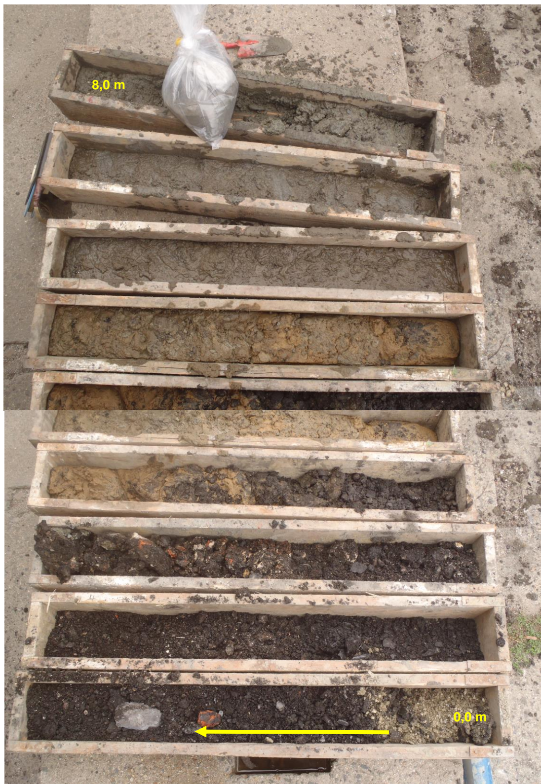
Foto 6: profil inženýrsko-geologického vrtu S-4 (0,0-8,0 m)
