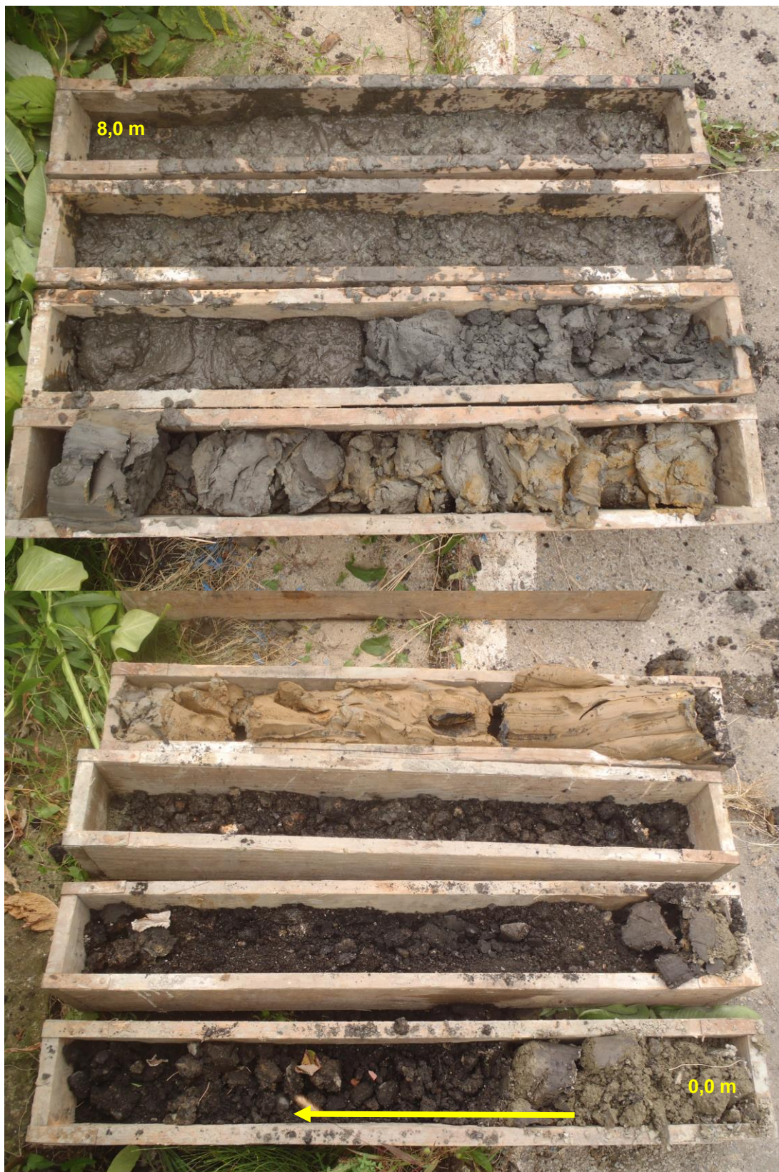
Foto 5: profil inženýrsko-geologického vrtu S-3 (0,0 – 8,0 m)
