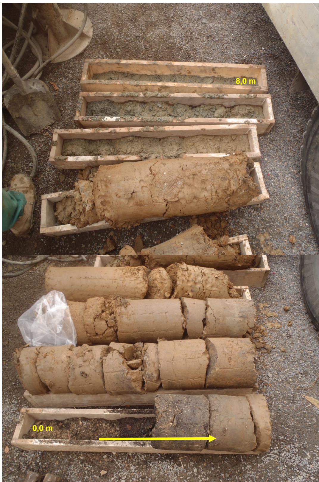
Foto 4: profil inženýrsko-geologického vrtu S-2 (0,0 – 8,0 m)
