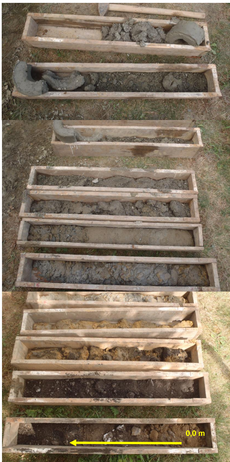
Foto 3: profil inženýrsko-geologického vrtu S-1 (0,0 – 9,7 m)
